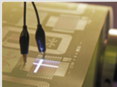
Siebgedruckte Elektroluminiszenz-Paste in Rolle-zu-Rolle-Prozess Reel-to-reel screen printed electroluminescence paste
