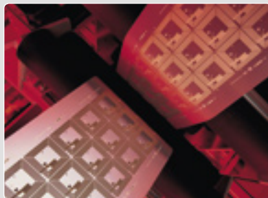
Smart Labels in Rolle-zu-Rolle-Verfahren gefertigt Reel to reel fabricated smart labels
