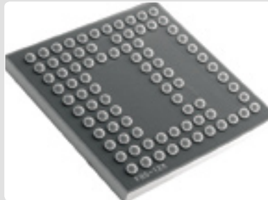
Integrierte passive Komponente mit 63 Dünnschicht-Widerständen (Größe: 6 x 6 mm 2 ) Integrated Passive Device (IPD) with 63 thin film resistors (total size: 6 x 6 mm 2 )
