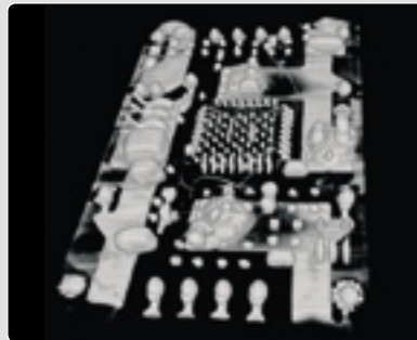
3D Computertomographie eines Leistungshalbleiter-Aufbaus 3D Computertomography of a power semiconductor assembly
