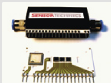
Abb. 3: MFC Demonstrator und MFC Schaltung mit Ventil und Sensoren
