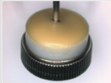
Beispiel für eine Leistungsdiode mit einer temporären flüssigen Lötverbindung
