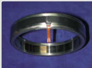
Vergossener Lagerring eines Wälzlagers
