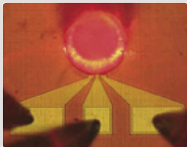
Elektrooptischer Wafer Level Test einer IZM SiGe PIN-Diode (24% Ge)
