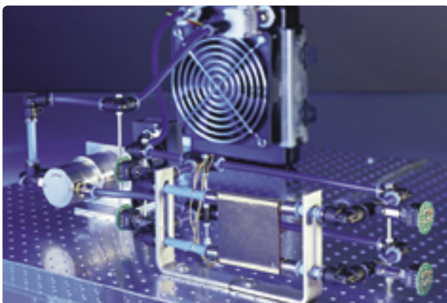
AlN Wasser-Mikrokanalkühler: Rechnergesteuerter Messplatz, hier in Closed-Loop Ausführung
