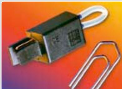
Silizium-Mikropumpe in Kunststoffgehäuse
