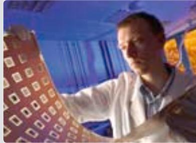
Vergraben gedünnter Chips durch Vakuum laminieren
