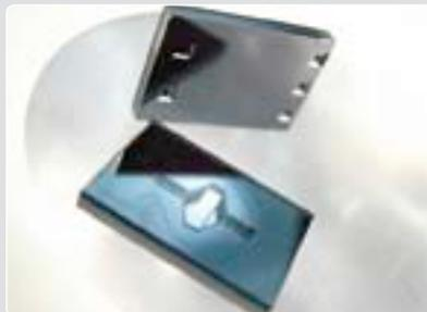
*MOEMS-Bauteil (nach Bonden und Vereinzeln), entwickelt in Kooperation mit Ricoh Ltd. Japan*
