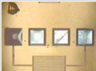
Selbstassemblierte Si-Chips auf Cu-Pads
