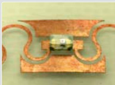
LED auf dehnbarem Substrat mit meandernden Cu Leiterbahnen. Cu-Strukturen zu beiden Seiten der LED dienen zur lokalen Versteifung des Substrates
