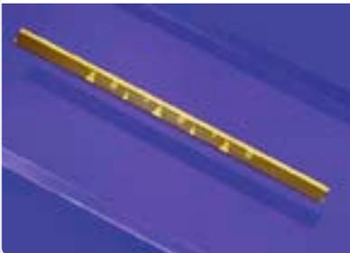
Thermooptischer Schalter aus Polymer. Sichtbar ist die aufgebrachte Schaltung
