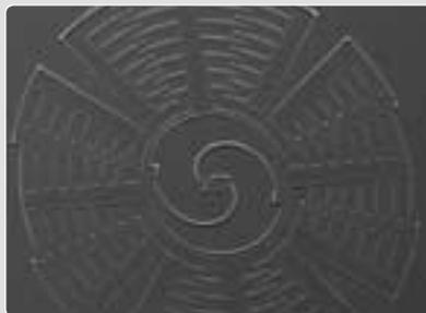
$\mu$ -Imprint einer Sensorstruktur in PMMA
