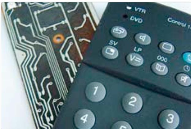
Lignin-basierte Leiterplatte für eine Fernbedienung
