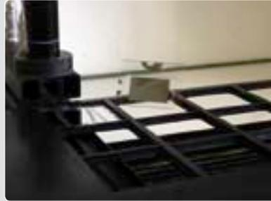
Messung der optischen Transmission der Calciumtestzellen mit Hilfe eines Lasers der Wellenlänge  $\lambda = 633$  nm und einer Photodiode als Detektor. Der Rahmen kann bis zu 15 Proben aufnehmen, die parallel unter den gleichen klimatischen Bedingungen untersucht werden können
