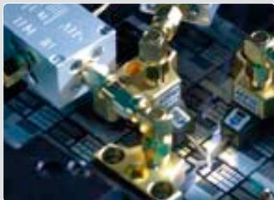
ATIS Transient Latch-Up (TLU) Modul zur Bestimmung der Empfindlichkeit von ICs im Gehäuse und auf dem Wafer gegenüber Impulsstörungen
