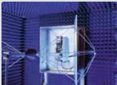
EMV-Testaufbau in der Absorberkammer
