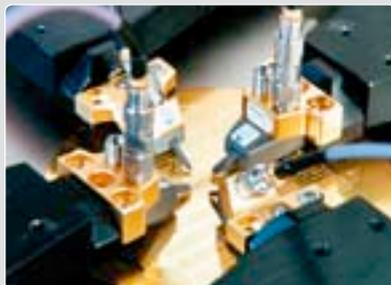
4-Port-Messplatz zur HF-Charakterisierung gekoppelter Strukturen
