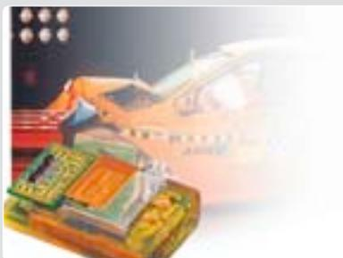
6-Kanal Datenlogger für Integration in Crash Test Dummies (Quelle: Fa. Messring)
