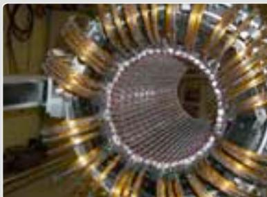
Die äußere Lage des ATLAS Pixeldetektors (mit freundlicher Genehmigung der ATLAS Pixel Collaboration); die mit externer Elektronik komplettierten Module werden auf sogenannte Staves montiert, welche wiederum zu einer Röhre zusammengesetzt werden
