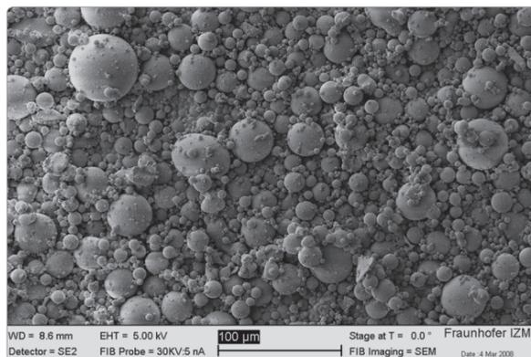
SiO<sub>2</sub> Mikro- und Nano-Füllstoffpartikel für Polymer-/Verkapselungsmaterial-Anpassung
