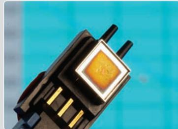
Mikropumpe in Kunststoffgehäuse
