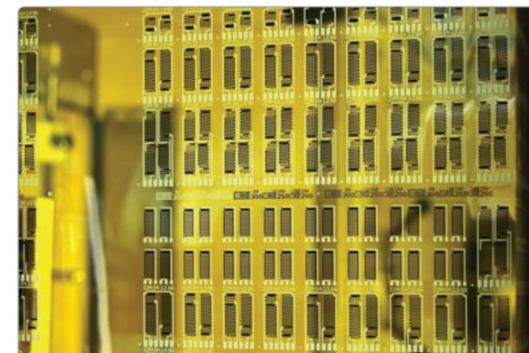
Im Rolle-zu-Rolle-Verfahren gedruckte Widerstände für die Sensorik
