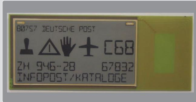
Smart Label (Elektronischer Infoträger - Passives RFID-System mit bistabilem Display zweite Generation)
