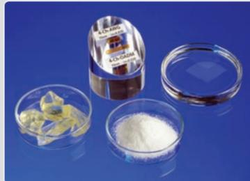
Entwicklung optischer Bauteile – vom Monomer über Prepolymer und Polymer zum athermischen AWG Vollpolymer.
