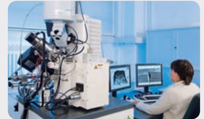
Lokale Eigenspannungsanalyse im FIB mit FIBDAC
