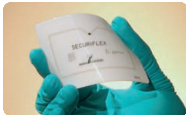
Extrem dünner Transponder für Sicherheitsdokumente
