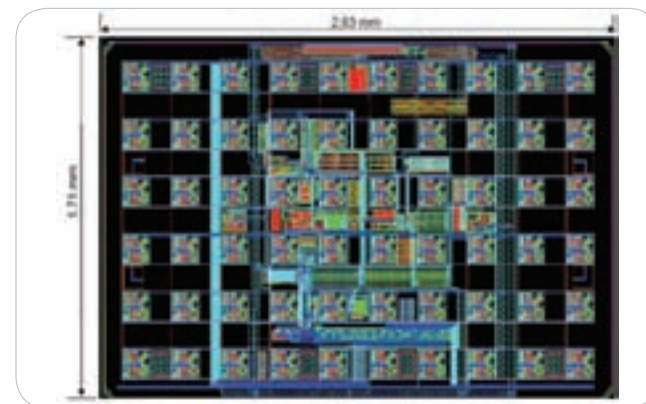
Sensor-Layout eines Stress-Messchips mit 6 x 10 Messzellen. Vier verschiedene Bauteilabmessungen stehen zur Verfügung
