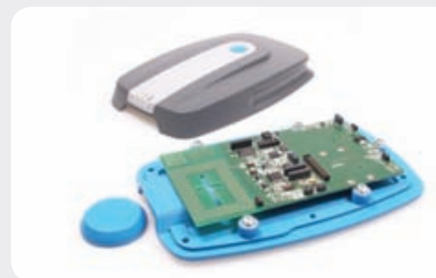
Multisensorsystem mit RFID-Schnittstelle, Kommunikation über GSM
