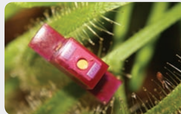
"Integrated Electronics": Generativ hergestelltes Sensorgehäuse
