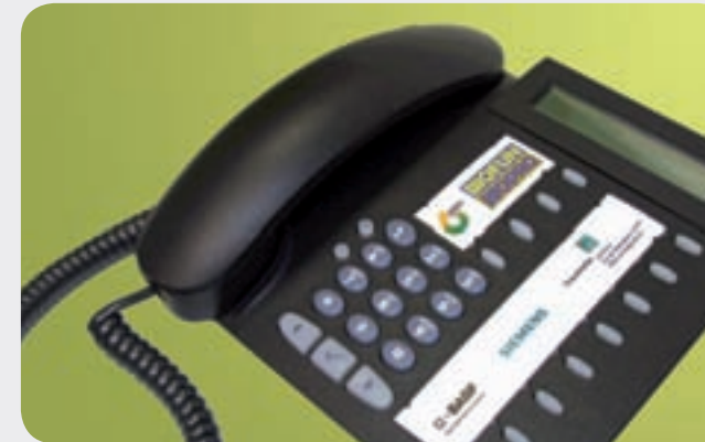
Ein funktionsfähiger Projektdemonstrator zeigt die Nutzungsmöglichkeiten nachwachsender Rohstoffe („Biokunststoffe“) in der Elektronik
