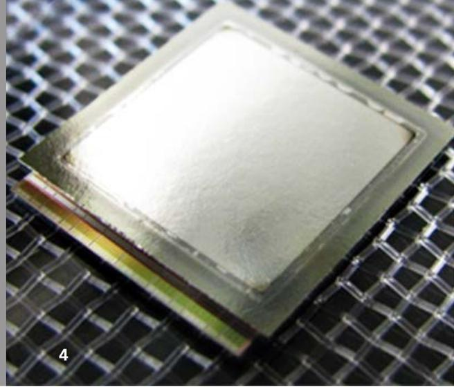
Beim anschließenden Assembly wurde jede der 256 x 256 Zellen der Ausleseelektronik mit einem Pixel des Sensors im Raster von nur 55 x 55 µm<sup>2</sup> elektrisch verbunden. Im Test der aufgebauten Detektormodule am DESY bei einer Temperatur von -100°C im Vakuum konnte ein gleichmäßiges Detektionsverhalten bei gleichzeitig hoher Pixelausbeute nachgewiesen werden.
