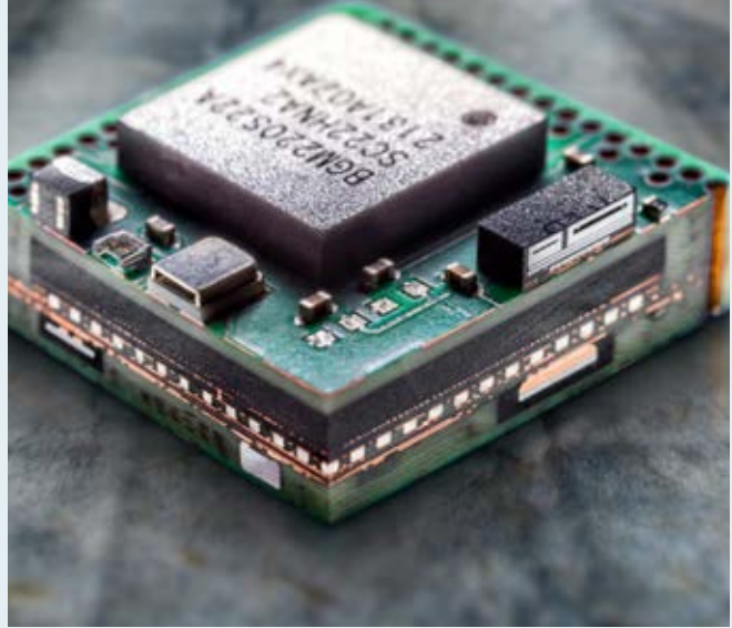
Hochminiaturisiertes Sensor- und Controller-Modul in Einbetttechnologie
