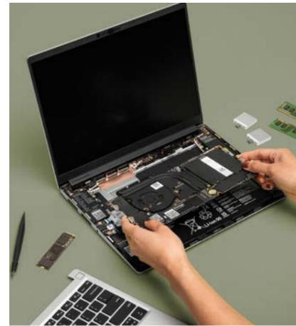
Vom Fraunhofer IZM öko-bilanzierter modularer Laptop der Firma Framework
