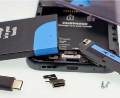
Einheitliche Ladeanschlüsse und modularer Geräteaufbau fördern die Circular Economy
